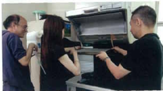
実験を準備しているところ（取り付け中のネットは油煙の広がりを遮断することがわかり、実験開始直後に外した）
