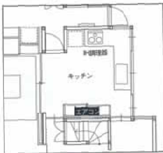
A邸のキッチン。換気風道を出して換気力を高める壁流板方式のIH調理器対応のレンジフードが設置されていた
